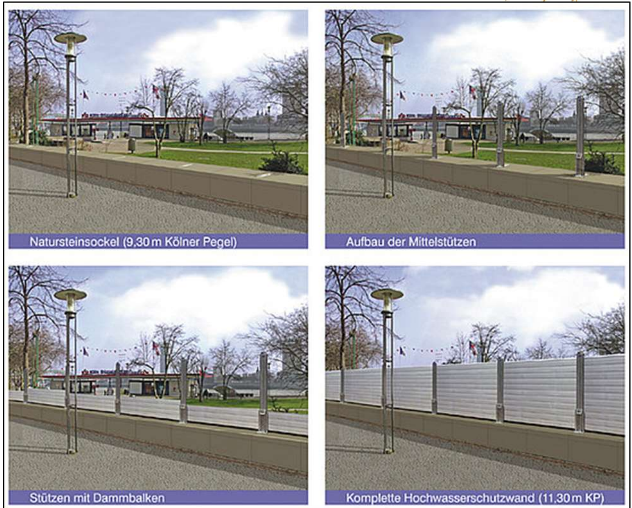
Figura 13 – Sequência de montagem de dique da IBS seguindo previsão de cheia ( www.hochwasserschutz.de )
