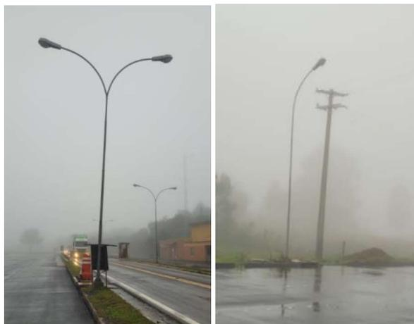
*Figura 3 e 4 – Postes metálicos curvos duplo e simples flangeado de 9 metros.*
